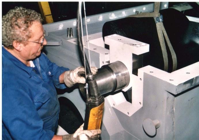
*Bild 4: Montage der Leitschaufeln mit Lagereinsatz im Turbinengehäuse*
