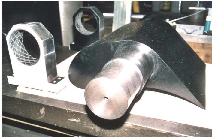
*Bild 3: Leitschaufel und Passlagereinsatz für die Leitschaufel*
